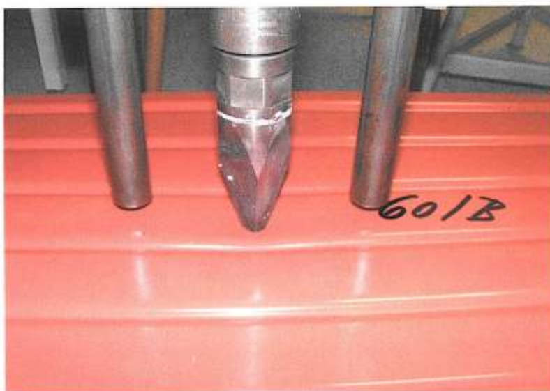
Foto 2 – Průraz zkušebního tělesa cca 20 mm. Bílá ryska označuje hloubku průrazu 100 mm.
