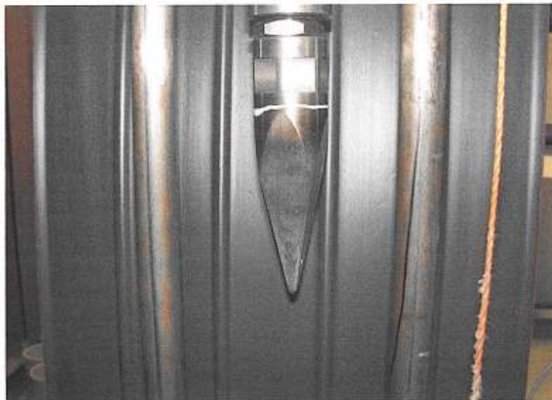
Foto 1 – Nárazník ve tvaru špiče podle ÖNORM E 6530, obrázek 3.
